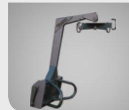
Grúa para trabajo con sistema Big-Bag más robusto y con lubricación en las articulaciones, permite trabajos intensos con elevada vida útil.
