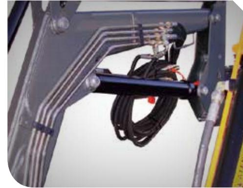
Mangueras de 1/2" (media pulgada) y tubos hidráulicos de 13 mm montados en lugares adecuados en la parte interna de la estructura, reduce el riesgo de daños por colisión y dimensionados para evitar el sobre calentamiento del sistema hidráulico del tractor.
