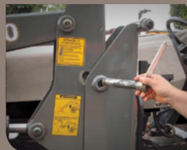
Sistema de enganche de la estructura al adaptador práctico y reforzado, utiliza apenas un perno, puede ser acoplada o desacoplada por el operador, disponibilizando rápidamente el tractor para otras operaciones agrícolas.
